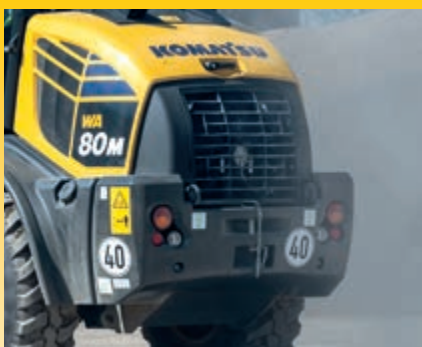
Radiador de malla ancha con ventilador reversible (opcional)
