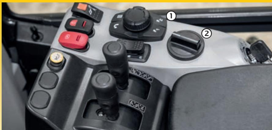
Controles de los nuevos diseños. El dial de comandos (1) facilita la cómoda navegación a través de los menús del panel del monitor, como un turismo. El nuevo dial de control de velocidad de desplazamiento (2) mantiene constante la velocidad de la máquina durante el descenso.
