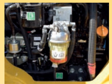
Filtro y prefiltro de combustible de mayor tamaño con decantador de agua que protegen el motor
