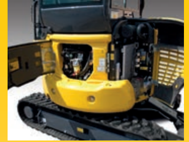
Capós traseros para revisión rápida del motor, inspección rápida, limpieza de los radiadores y fácil acceso a la batería
