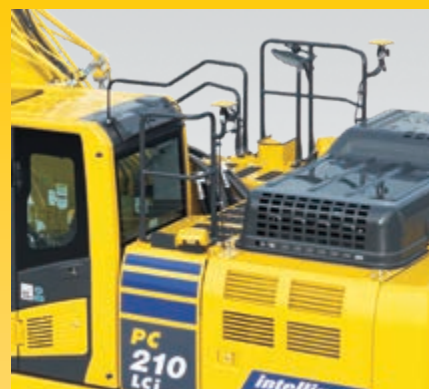
Barandillas y placas antideslizantes
