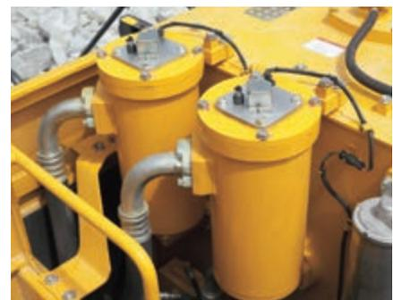
*Indicador de suciedad en los filtros de retorno hidráulico ayuda a prevenir los daños del sistema hidráulico*
