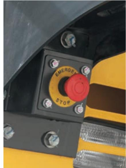
Tres interruptores de parada de emergencia del motor están instalados de serie en la cabina y alrededor de la máquina.
