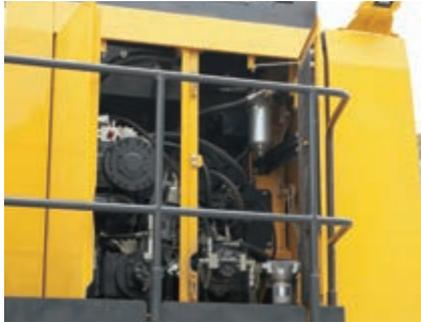
Una pasarela amplia iluminada permite un acceso fácil para la inspección y el mantenimiento. Además, los puntos de inspección y mantenimiento están agrupados para facilitar la comprobación del motor y de los componentes hidráulicos.
