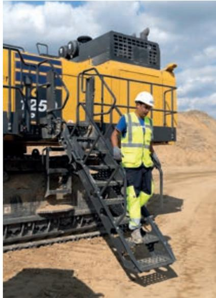
La escalera con accionamiento hidráulico de serie permite acceder y salir de la cabina con seguridad.
