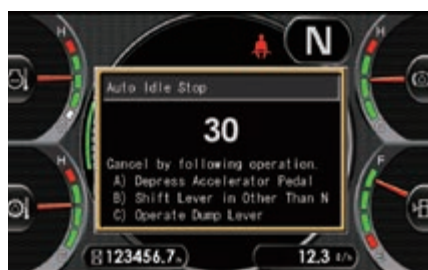
Apagado automático a ralentí ajustable
