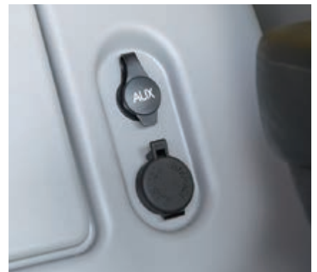
Entrada auxiliar (clavija MP3) y puerto de 12 voltios
