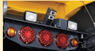
Cámaras para visibilidad trasera y KomVision
