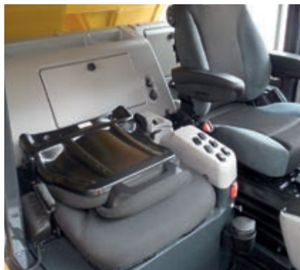
El asiento para el formador, del mismo tamaño que el del operador, es plegable y tiene cinturón retráctil de 2 puntos
