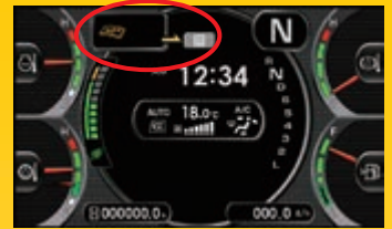
Precaución por mantenimiento
