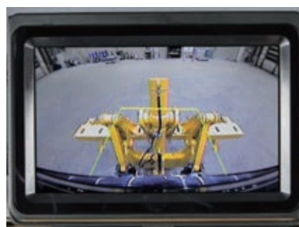
Sistema integrado de cámara para visibilidad trasera
