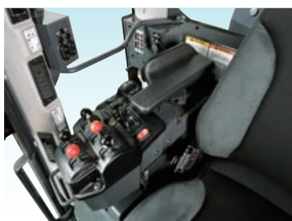
La altura de la consola del brazo puede ajustarse eléctricamente
