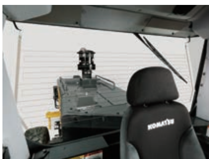
El capó del motor bajo y ancho ofrece una visión trasera clara
