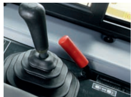
Palancas de bloqueo de seguridad remotas
