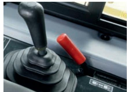
Palancas de bloqueo de seguridad remotas
