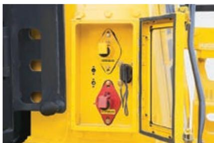
*Desconector de batería automático (opcional en la especificación para minería) con espacio para pinzas de arranque.*
