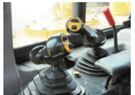
Palanca de control de la hoja con función de pitch automático y nueva palanca de control del ripper con función de retorno automático
